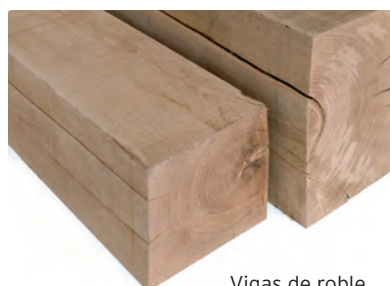
Vigas de roble
