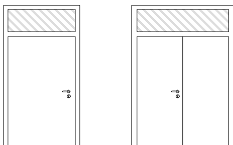
SOPRALUCE / WINDOW TRANSOM / IMPOSTE VITRÉE
