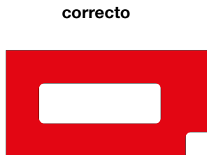
FRESADOS EN LA PLACA FUN- DERMAX COMPACT
